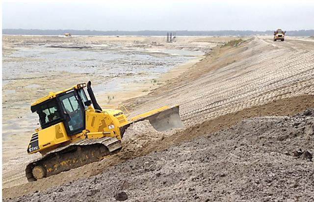
世界初\*の全自動ブレード制御機能を搭載した中型ICTブルドーザー「D61PXi-23」
