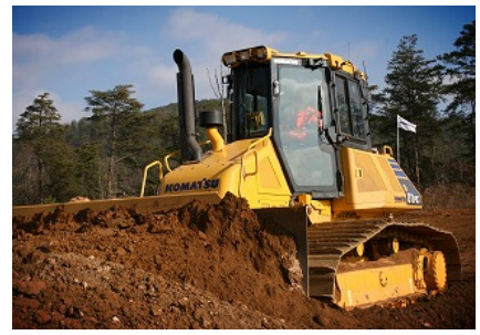
全自動ブレード制御機能を搭載した 中型ICTブルドーザ「D61PXi」
