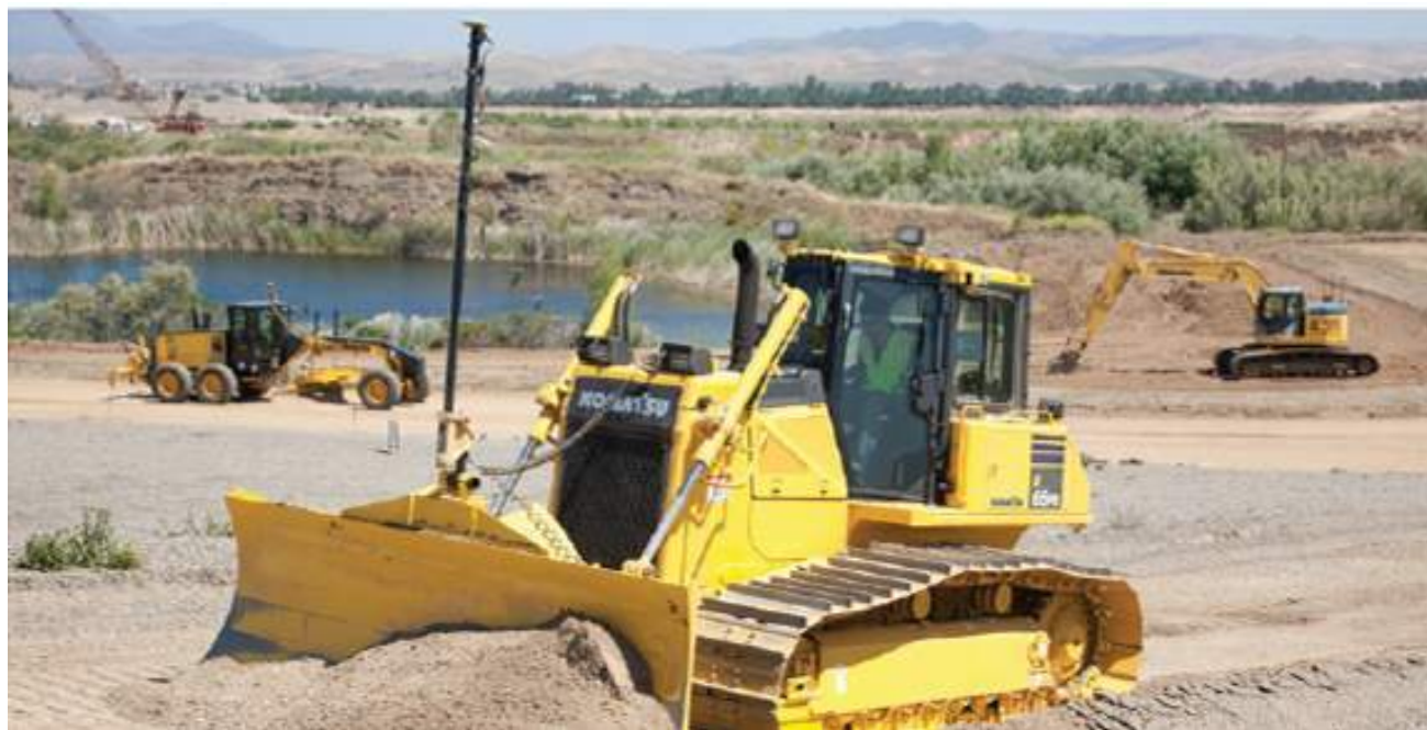
ブレードの自動制御機能を 搭載したブルドーザ 「D65-17」
