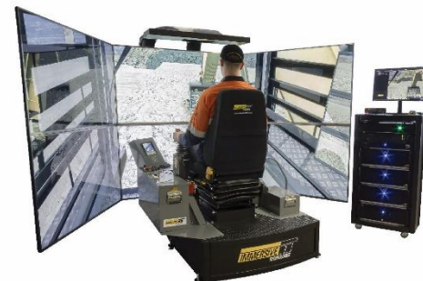
鉱山機械向けシミュレータ 2019年7月に買収した「イマーシブ社」製
