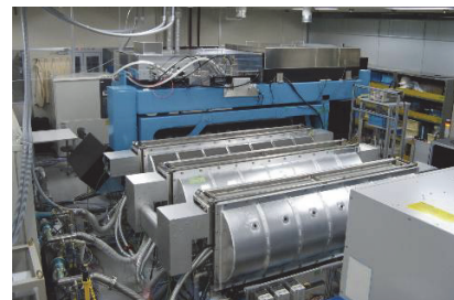
図7 CO 2 増幅実験装置 (三菱電機(株)提供)
