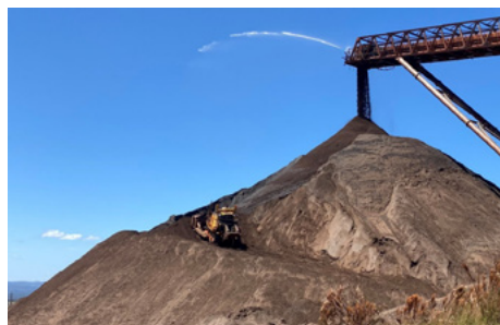
鉱山でストックパイルオペレーションを行う遠隔操作ブルドーザー
