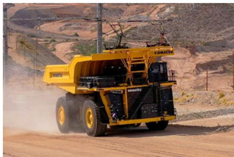
鉱山向けトローリー給電式バッテリーダンプトラック (コンセプトマシン)
