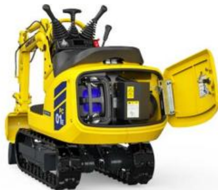
写真-3 プロジェクト A-① バッテリー駆動式電動マイクロショベル PC01E-2 (一例)
