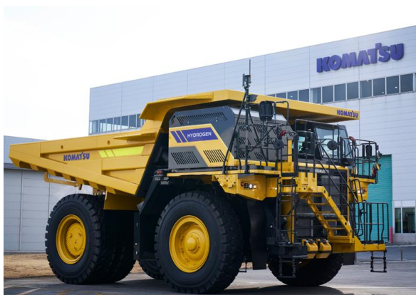
写真-4 プロジェクト A-① 水素エンジン搭載大型ダンプトラックのコンセプトマシン(一例)
