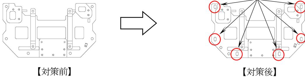
ブルドーザの排気管において、ベローズ部の溶接が不適切なものがある。また、排気管を車体に固定する構造が不適切なため、ベローズがねじれて組み付けられたものがある。そのため車体振動によりベローズ部に亀裂が生じ、ベローズが破断して排気ガスが漏れるおそれがある。
