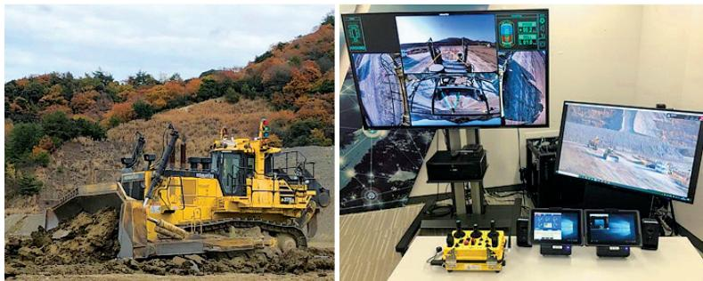
【商用5Gを利用した鉱山向け大型ICTブルドーザー「D375Ai-8」の遠隔操作
