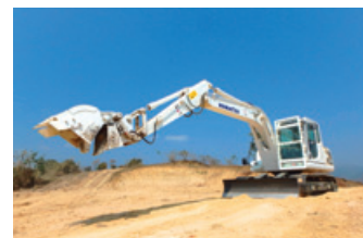
【PC130油圧ショベルベースの 対人地雷除去機 (不発弾処理用)】
