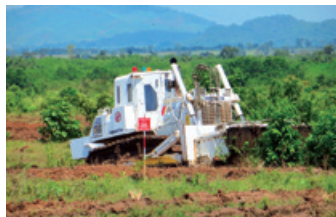
【D85ブルドーザーベースの 対人地雷除去機】
