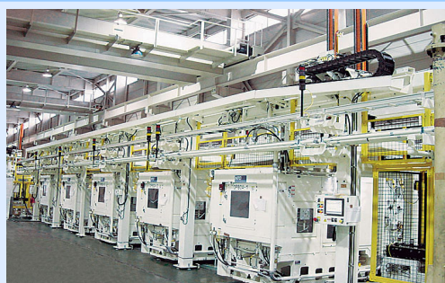
トランスファマシン (自動車部品加工) [コマツNTC]
