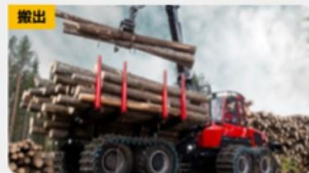
搬出 傾斜地にも対応する集材作業車 フォワーダー895
