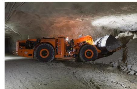
坑内掘り向け鉱山機械 (ロードホールダンプ)
