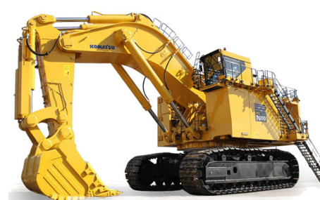
超大型油圧ショベル
