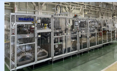
半導体シリコンウエハー用 ワイヤーソー [コマツNTC]
