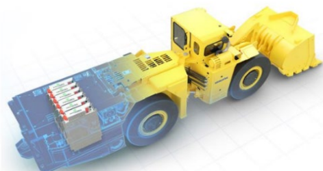
プロテラ社リチウムイオンバッテリー 搭載のLHDのイメージ
