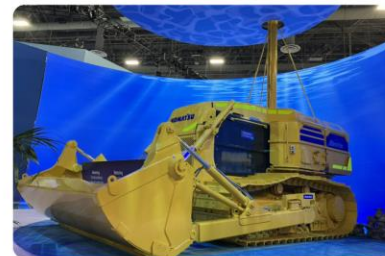
水中施工ロボット
