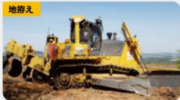
地拵え 地拵え用機械 D85EX サブソイラー
