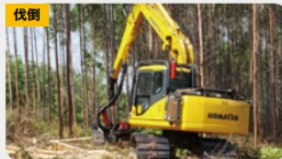
伐倒 油圧ショベルベースの林業機械 PC130F ハーベスター仕様
