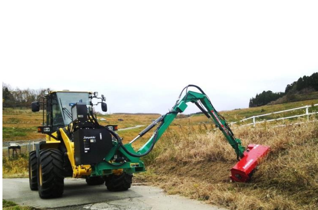
多機能ホイールローダーによる 除草・運土作業（耕作地再生・省力化）
