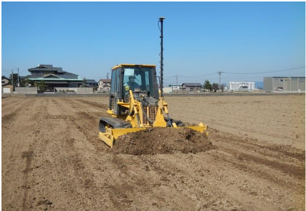
多機能ICTブルドーザーによる 圃場の高精度均平化（収量向上）
