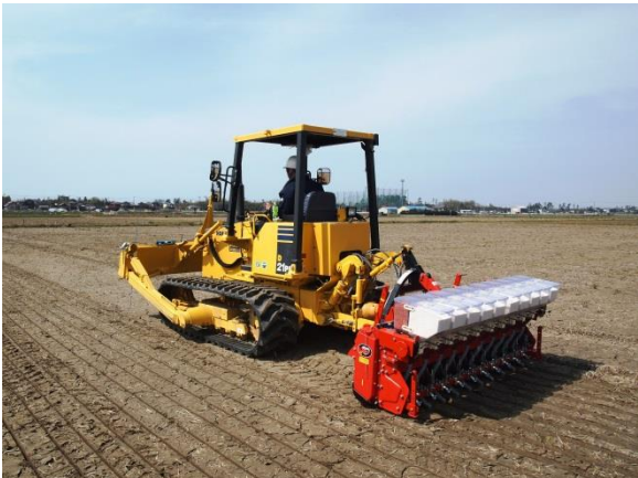
多機能ICTブルドーザーによる 水稲直播栽培（工数・機械費低減）
