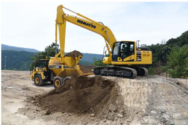
本年9月より日本で販売を開始した 中型油圧ショベル「PC200-11」 (オフロード法2014年基準適合)
