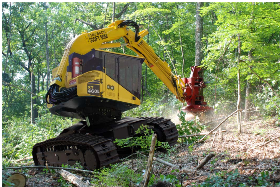
Quadco製のフェリングヘッドを搭載したコマツの林業機械
