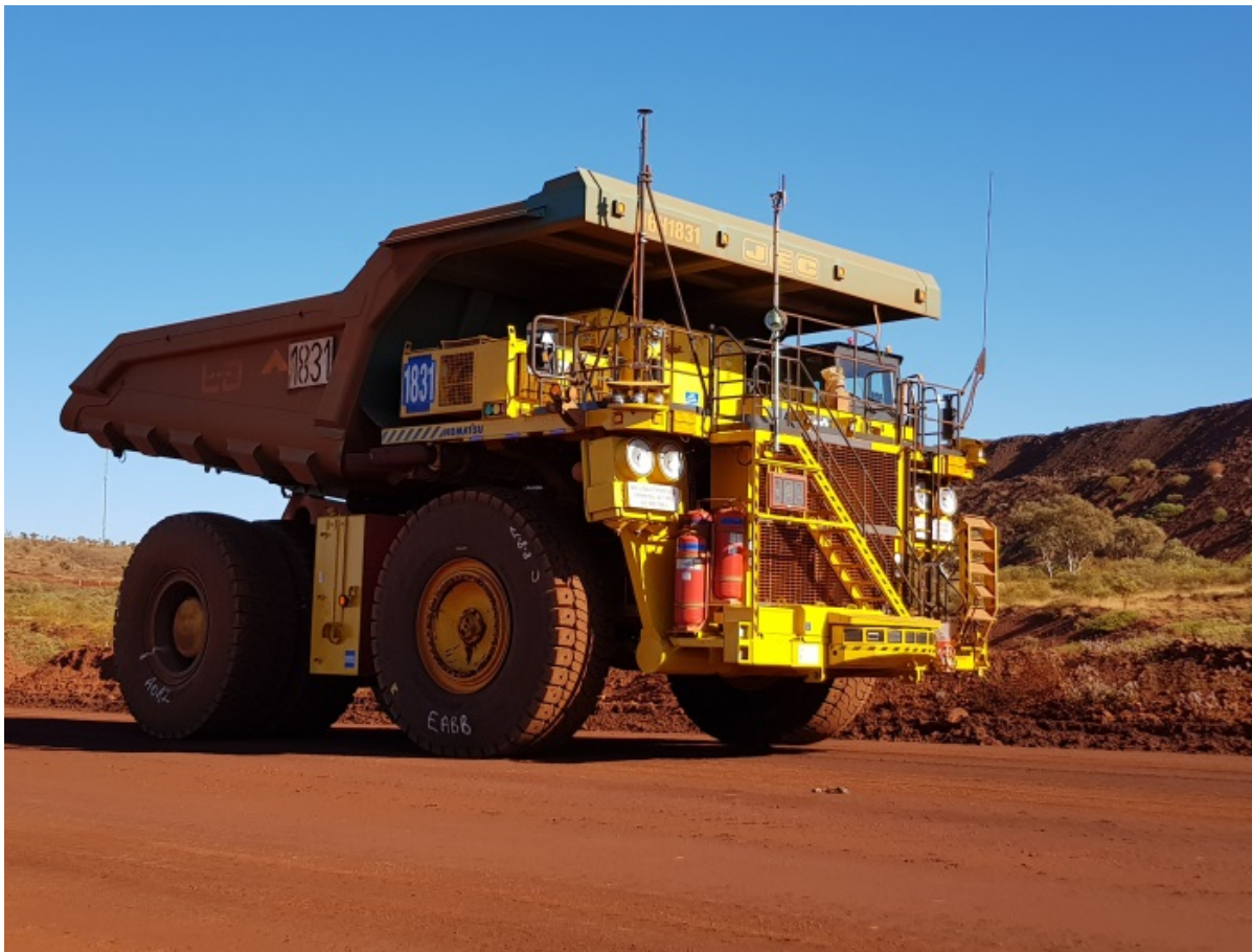
AHS改造後付キットを搭載し 無人稼働する830E (場所：豪州リオ ティント社鉄鉱山)
