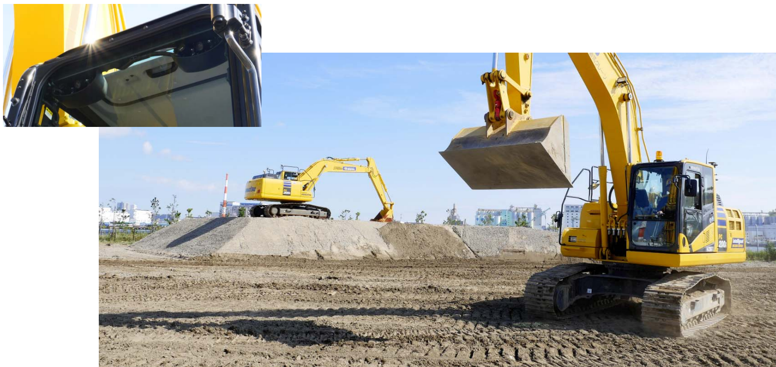
ステレオカメラ※搭載のPC200i(※:ICT建機に搭載し、車体周辺の地形形状を常に高速、高精度に計測するシステム)
