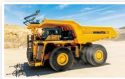
パワーアグノスティックダンプトラックのコンセプト車
