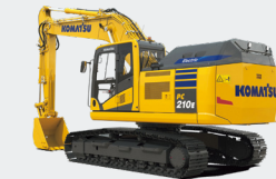
リチウムイオンバッテリー搭載20トンクラス新型電動ショベル「PC200LCE-11」
