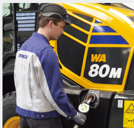
ドイツノーバーの工場ではHVO燃料を充填する様子
