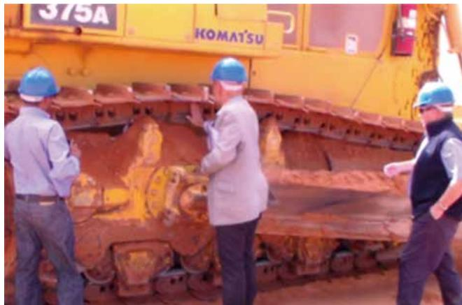
■ ブルドーザー「D375A」の足回りの磨耗を調査しています。
