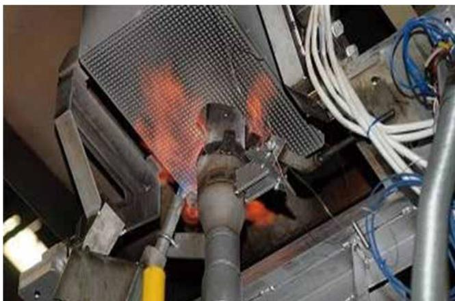
■ 温度差で発電する「熱電素子」を使った廃熱発電システム（粟津工場）。熱処理は温度を急激に変化するので非常に過酷な条件です。
