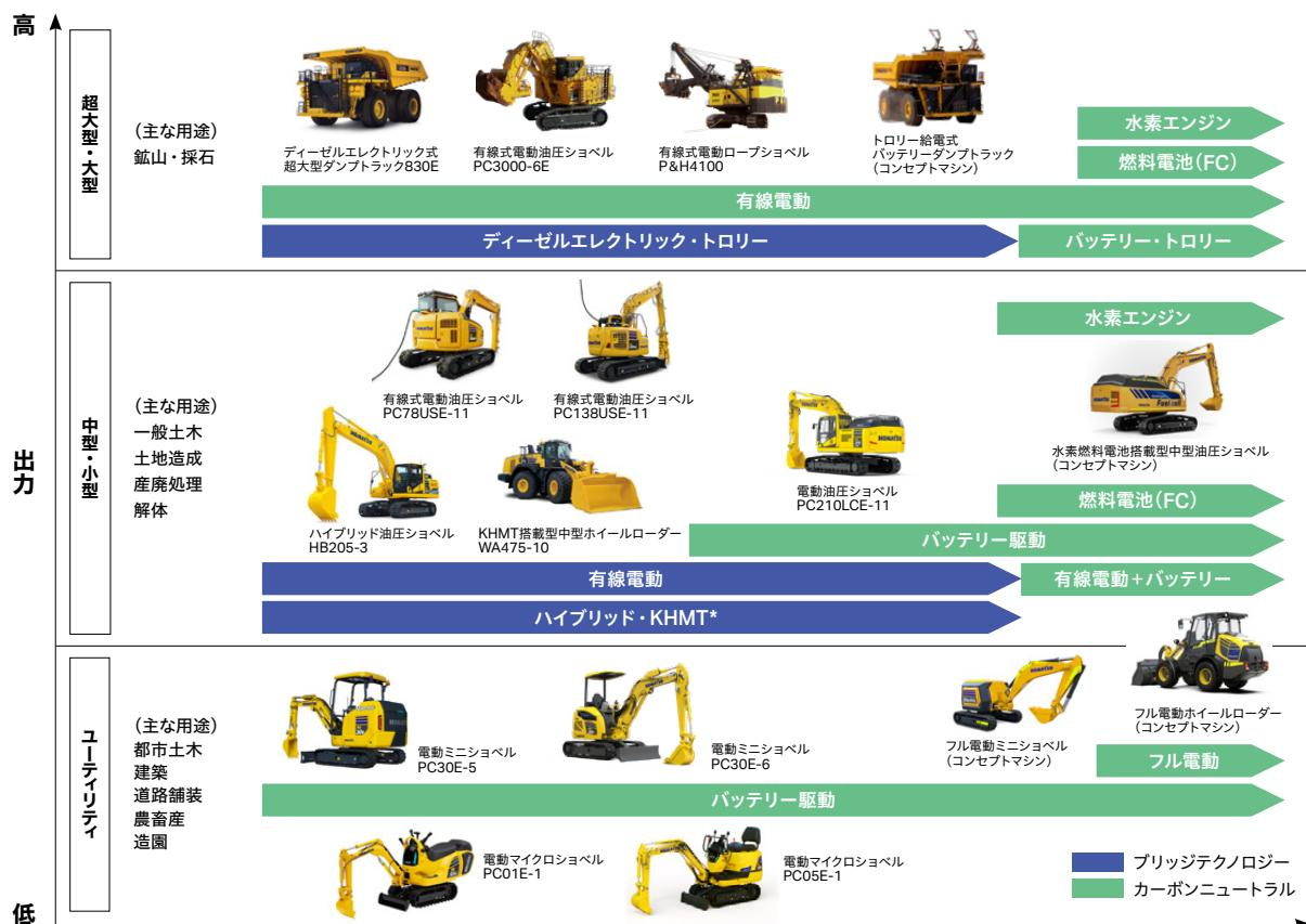
\*Komatsu Hydraulic Mechanical Transmission (KHMT): 可変容量油圧ポンプとモーターを使用した無段階変速可能なハイドロスタティックトランスマッシャン(HST)と、高効率なメカニカルトランスマッシャンを組み合わせ、従来機と比べ燃費効率を30%向上させたトランスマッシャン
