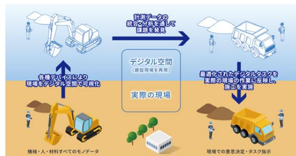
「DXスマートコンストラクション」による“デジタルツイン”施工
