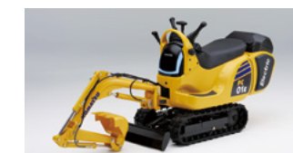
Honda Mobile Power Pack搭載の電動マイクロショベルPC01(試作車)
