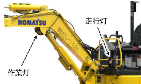
図16 作業灯と走行灯
