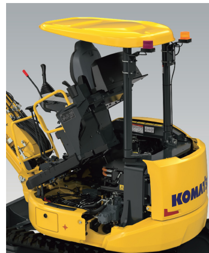
図12 チルトアップフロア構造 (カタログより引用)
