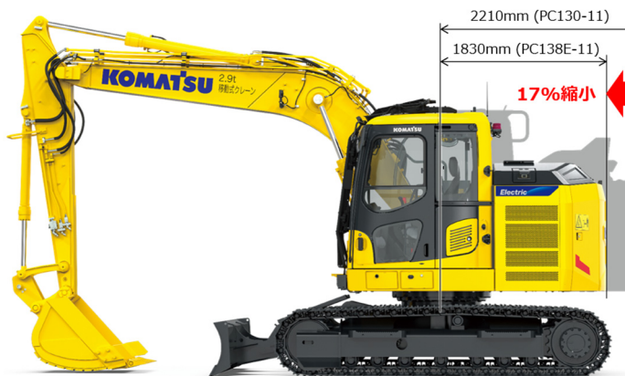
図6 PC138E-11の後端旋回半径
