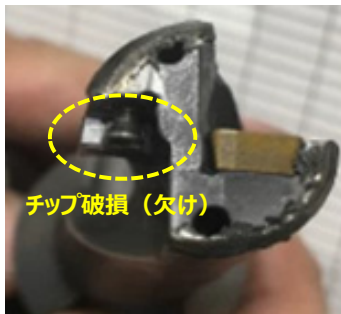
図4 工具刃先の破損（欠け）
