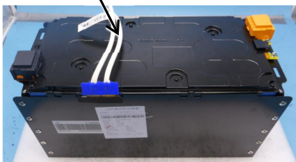
図5 バッテリーモジュールとヒーター配線
