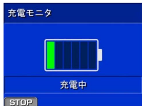
図12 自動充電開始時の車体モニタパネル
