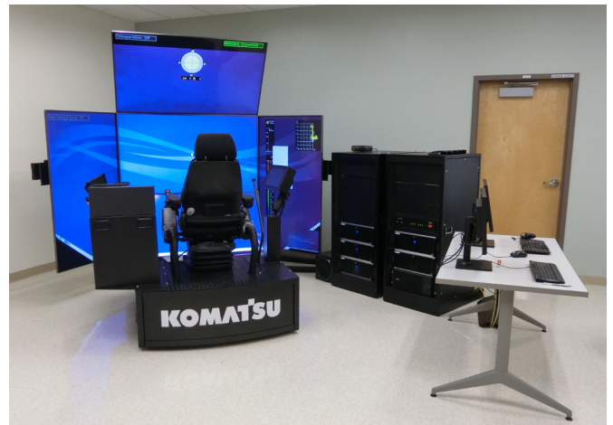
図4 遠隔操作席（全景）
