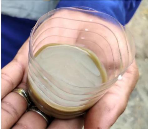
図10 水分が混入し乳化した油
