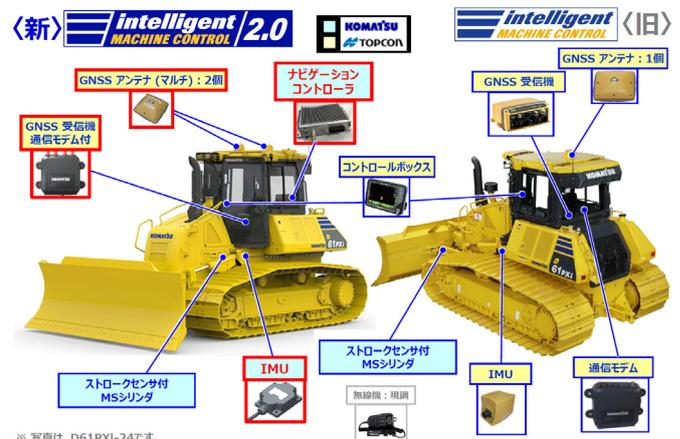
図13 新ICTシステム搭載機器
