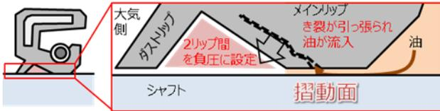
図6 ダストリップ付オイルシールの接触部模式図
