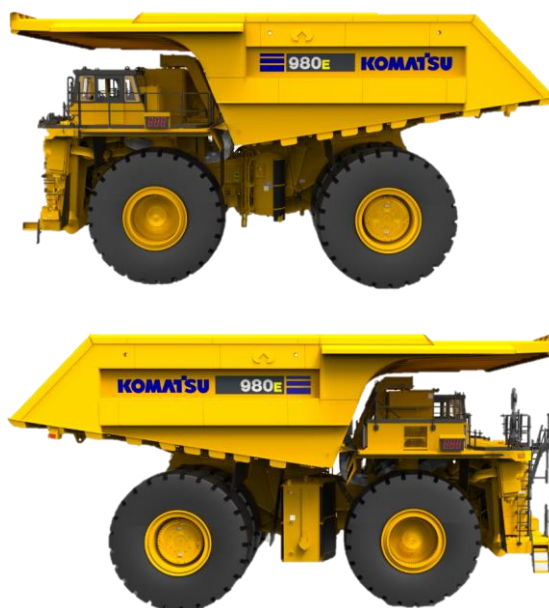
図1 980E-4の側面 (図は特注ボディを搭載したもの)
