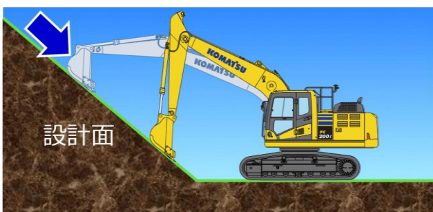
図5 バケット角度保持制御
