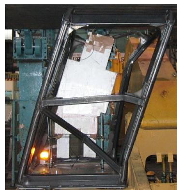
図2 品質確認試験後のキャブ
