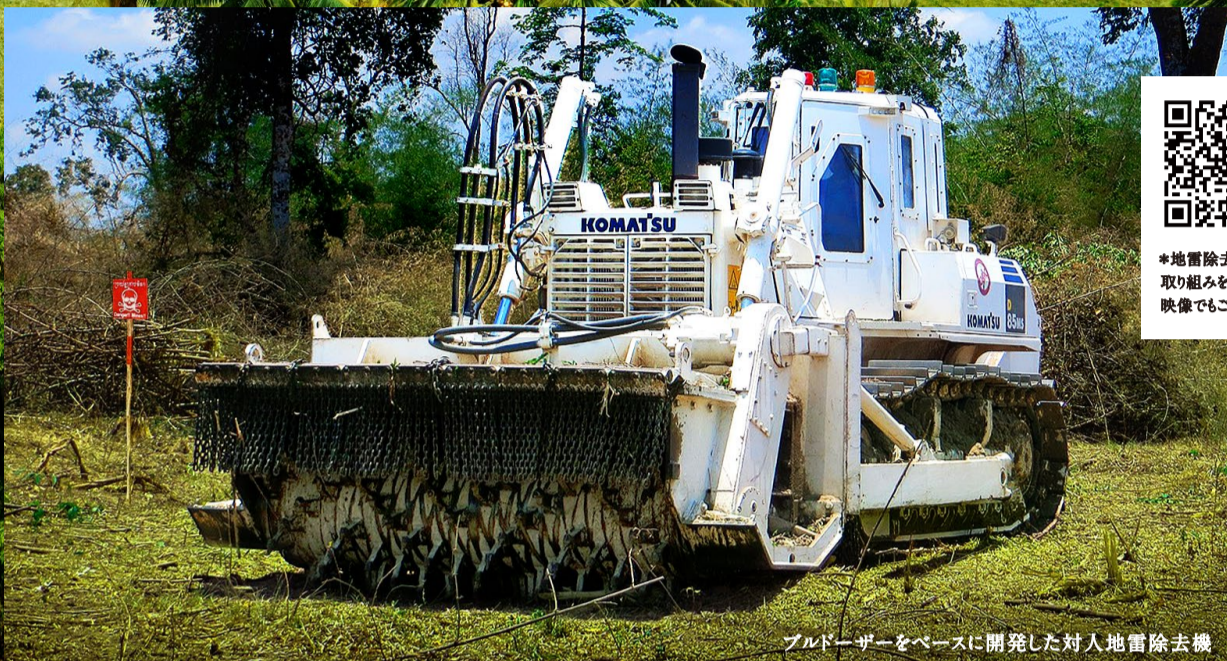
ブルドーザーをベースに開発した対人地雷除去機
