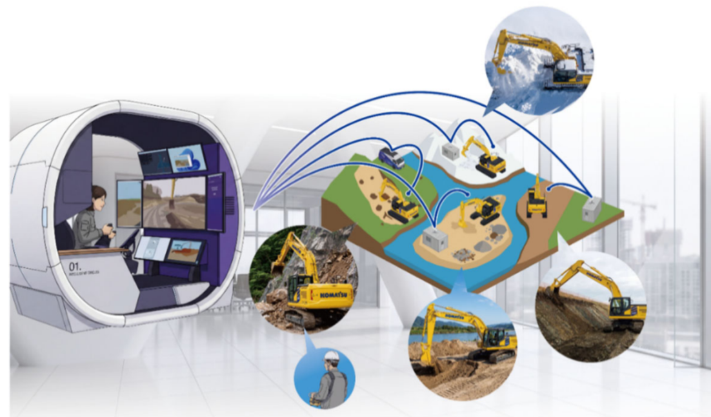
PC200i-12 遠隔システム仕様と遠隔操作システムが実現する現場イメージ
