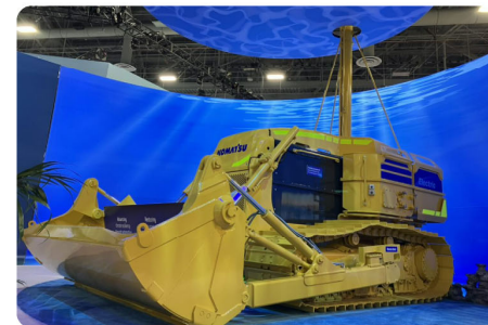
水中施工ロボット
