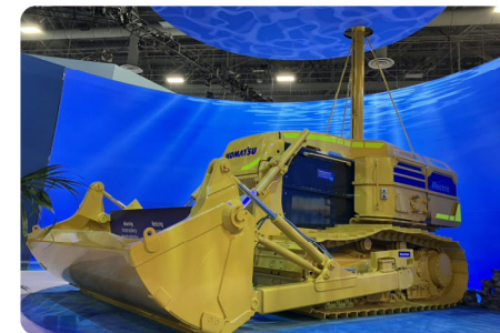
水中施工ロボット
