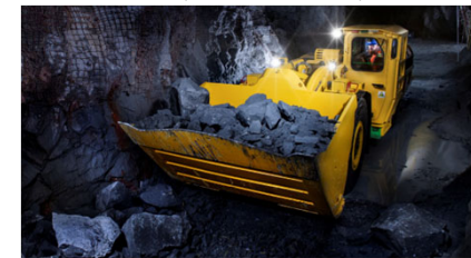
ロードホールダンブ (坑内掘り鉱山機械)
