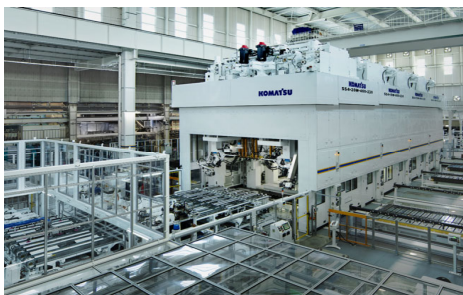
大型A Cサーボプレス (自動車ボディ成形用) [コマツ産機]
