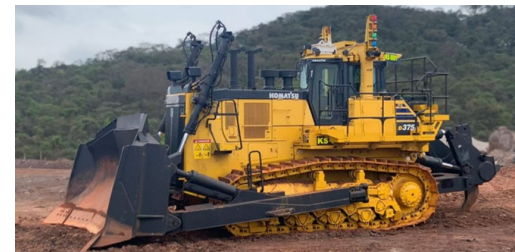
鉱山向け大型ICTブルドーザーと遠隔操作の様子
