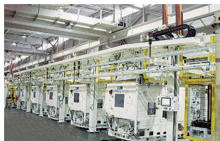
トランスファーマシン （自動車部品加工） 〔コマツNTC〕
