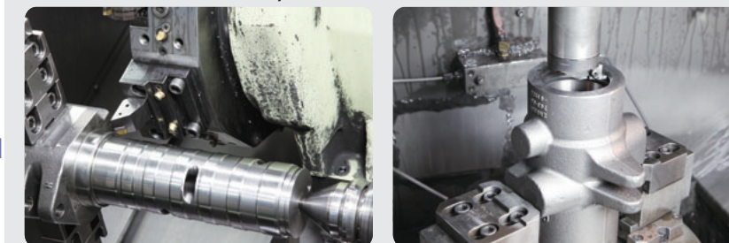
溝加工[シャフト] Grooving (shaft) 内径切削[ロータ] Boring (rotor)
