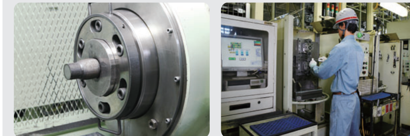
軸肥大加工[ギヤ] Partial diameter enlargement (gear) アルミ加工[FMSライン] Automated aluminum processing (FMS line)
