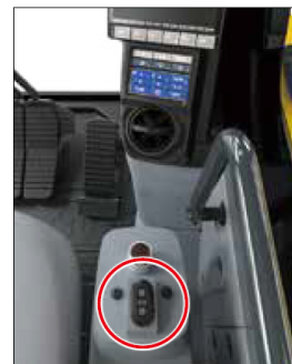
Fig. 17 On-hand gear shift switch
