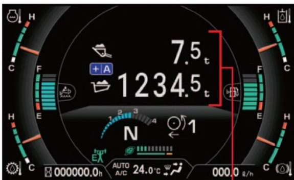
Fig. 6 Load meter new function switch
