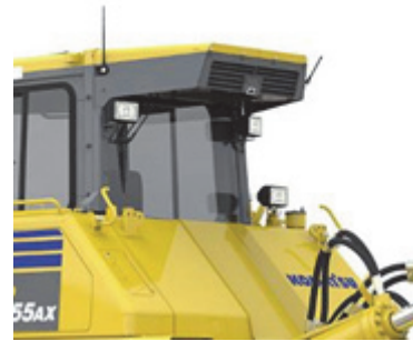
Fig. 13 Air conditioner condenser
