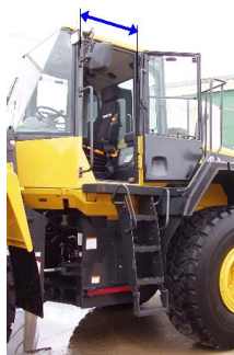
Fig. 16 Wider door opening width
