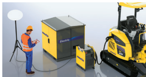
【ミニショベル向け蓄電機能付き充電器(中央奥)と 3トンクラスの電動ミニショベル(右)のイメージ】
