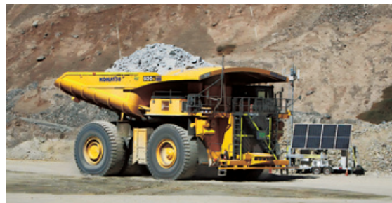
【Los Bronces銅鉱山で稼働する 無人の超大型ダンプトラック 930E】
