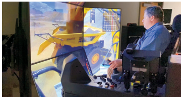
【遠隔操作用コンソール】
