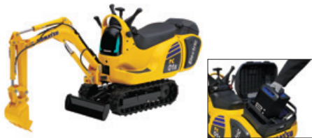
【左:電動マイクロショベル PC01E-1 右: Honda Mobile Power Pack e】
