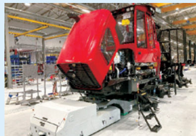
【AGV*を活用した自動牽引組み立てライン】
