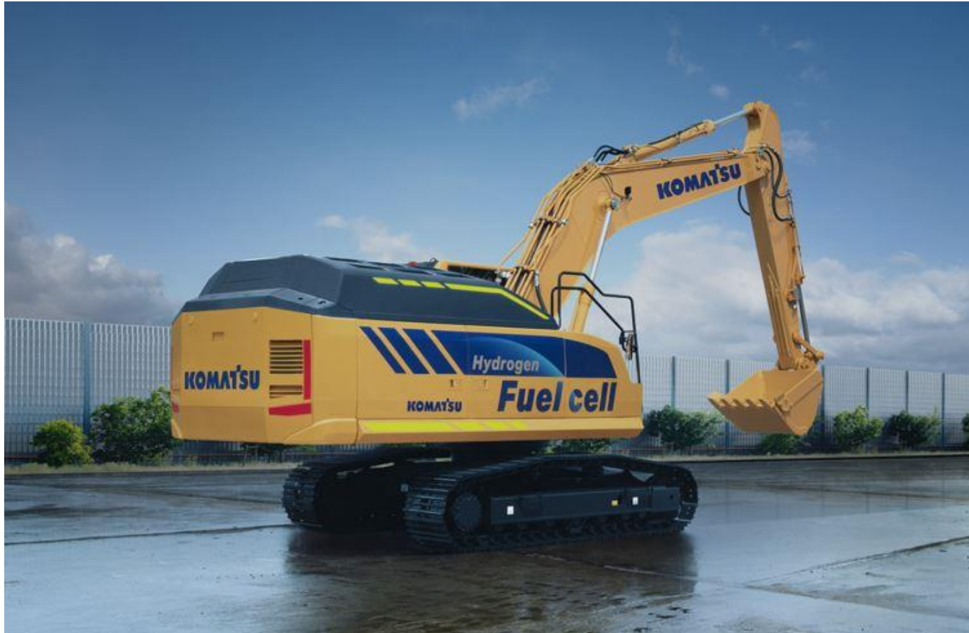
【写真】 水素燃料電池を搭載した中型油圧ショベル（コンセプトマシン）
